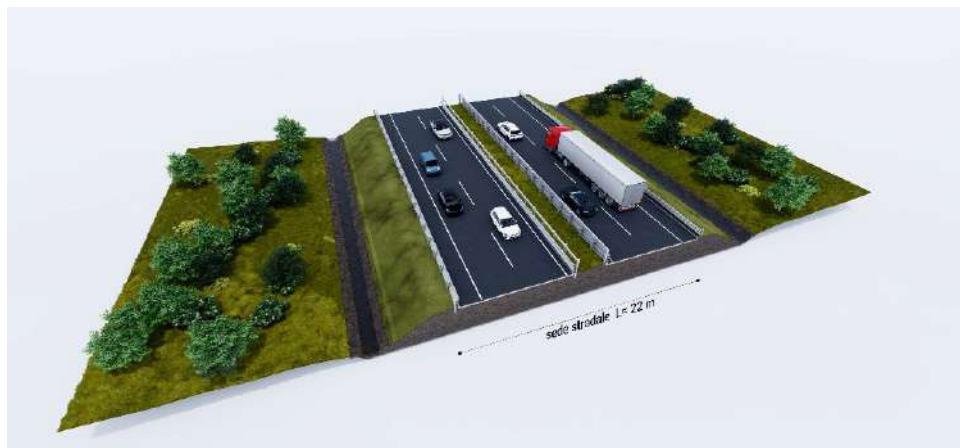
FIGURA 3-1 - SEZIONE TIPO STRADA DI CATEGORIA "B"
